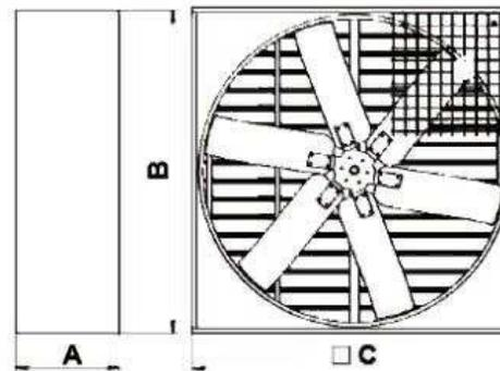
Корпус вентилятора изготовлен из оцинкованной стали. Лопасты рабочего колеса самоочищающиеся, изготовлены из прочной нержавеющей стали., шкив вентилятора и крестовина рабочего колеса из высококачественного сплава алюминия, отливаются под давлением. Это обеспечивает высокую прочность и надежность деталей.
