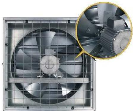
Вентиляторы туннельного типа серии НУ используются в помещениях, где необходимо обеспечить медленную циркуляцию больших объемов воздуха. Они работают в системах вентиляции обменного типа в зданиях промышленного, жилого, административного и сельскохозяйственного назначения. Вентиляторы НУ - это осевые вентиляторы с клиноременной передачей, низконапорные, с повышенной производительностью. Все компоненты
